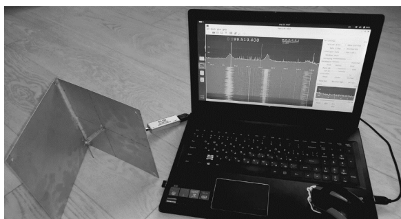
Рис. 3. Измерительная система для оценки сигнала ПЭМИН тактовой частоты видеointерфейса HDMI
