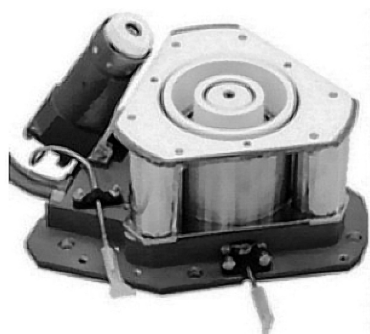
Рис. 10. Двигатели СПД-50 и SPT-50M: внешний вид и характеристики
