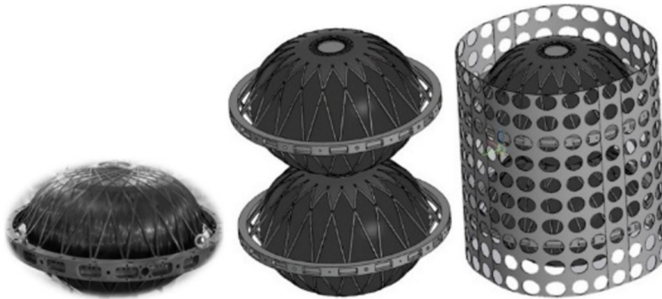
Рис. 4. Баки СХП (слева направо): фотография бака, 3D-модель двух баков, модель двух баков внутри фермы
